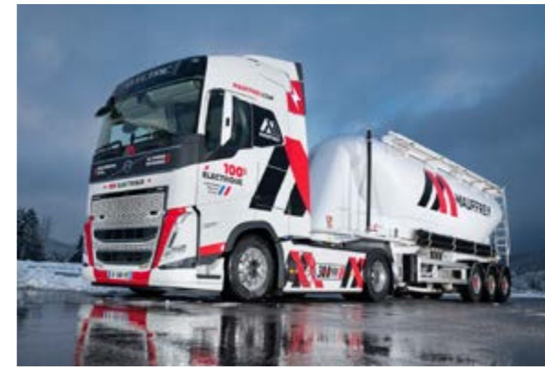
Le FH Electric 44T dispose d'une charge utile de 26,5T. Avec une puissance de 490 kW (soit + de 660 ch), ce sont 3 moteurs qui sont installés ainsi que 6 batteries.
